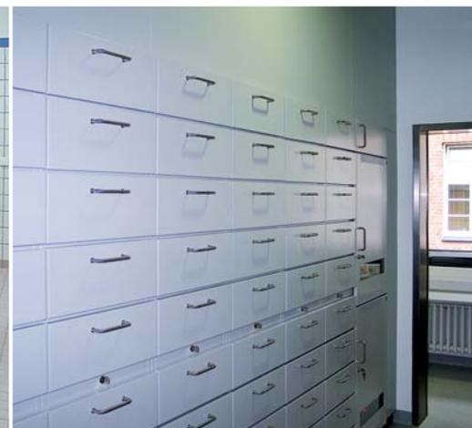
Schubladenschrankanlage mit Zentralverschluss zur Medikamentenlagerung
